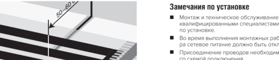
Рис. 1. Схема установки датчика температуры пола
